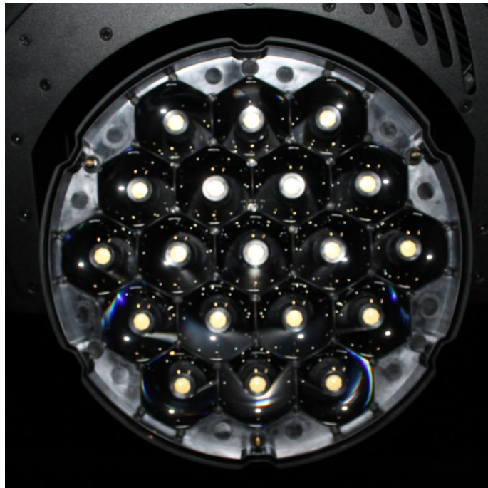
Bild 2 Ansicht auf die LED's mit Optiken
